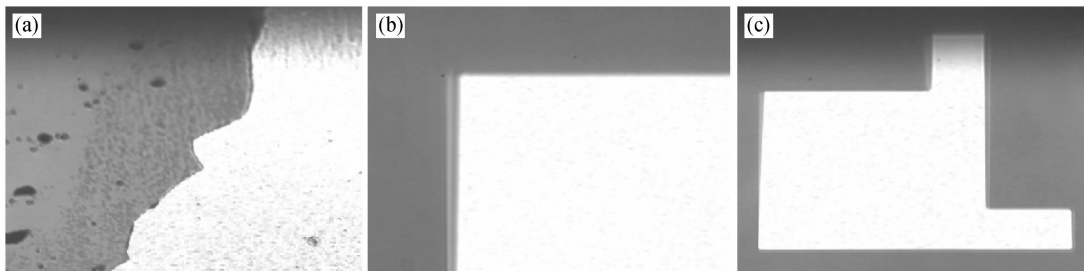
图 5 底电极的图形化效果图 (a)高温溅射制备的底电极; (b), (c)低温溅射后热处理制备的底电极
