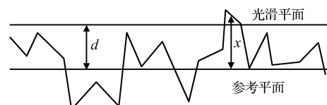
图3 芯片和抛光垫的接触
