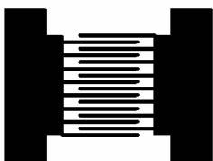
图 3 MSM 紫外探测器的示意图 Fig. 3 Figure of the MSM ultraviolet photodetector
