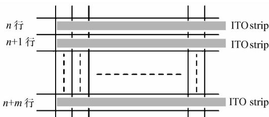
图 4 同行源极相连示意图 (■ ITO strip)
