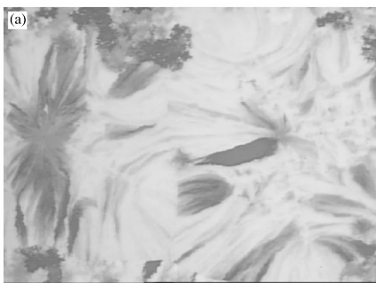
图 5 有(a)、无(b)PSG 吸除的 MIC 多晶硅经 TMAH 腐蚀后相邻两晶粒的显微照片
