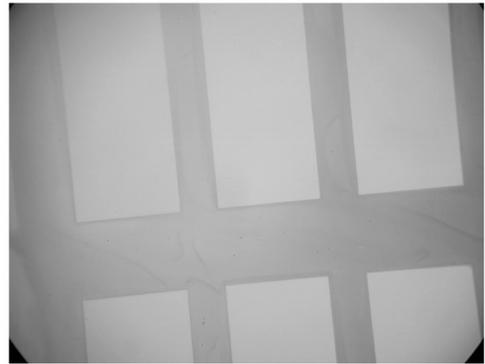
图 3 刻蚀前用 AZ9912 做掩膜的硅片表面显微镜照片(线宽分别为 10 和  $20\mu\text{m}$ )
