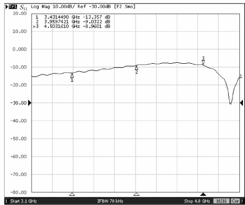
图 8 Mixer LO 端口反射特性 ( S_{11} < -9\text{dB} )
