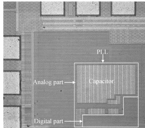
Fig. 11 Die micrograph of the PLL
