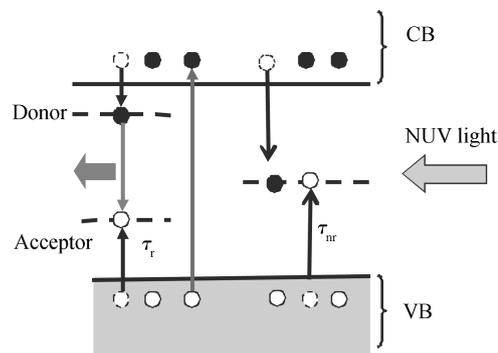
Fig. 4. Band diagram of f-SiC.
