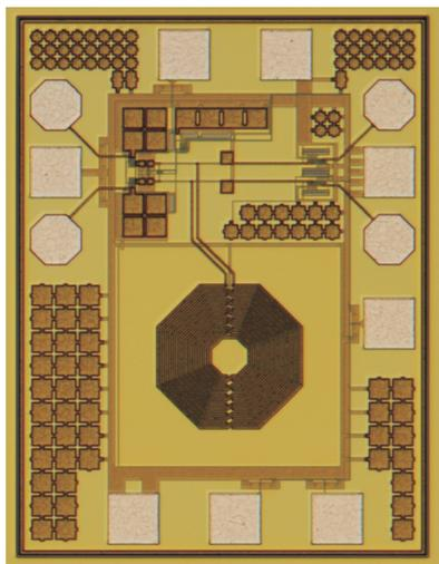
Fig. 9. Chip micro photo of the LNA.
