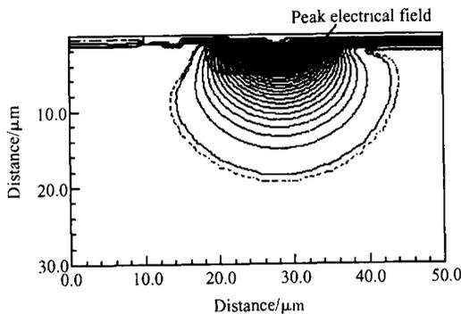
Fig. 7 Equipotential contours of HV-nMOS  $V_{gs} = 0\text{V}$ ,  $V_{ds} = 140\text{V}$ ,  $L_1 = 3\mu\text{m}$
