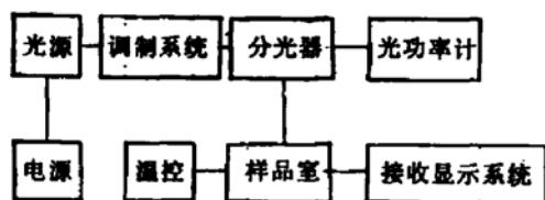
图 1  $\sigma_{ph}$ - $G$  和瞬态测试系统
