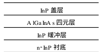
图1 In/A lGa lna s/InP 三明治结构
