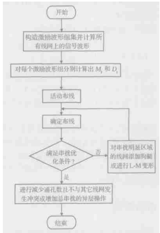
图 2 动态串扰优化的开关盒布线算法 Fig. 2 Dynamic crosstalk optimizing algorithm for switchbox routing
