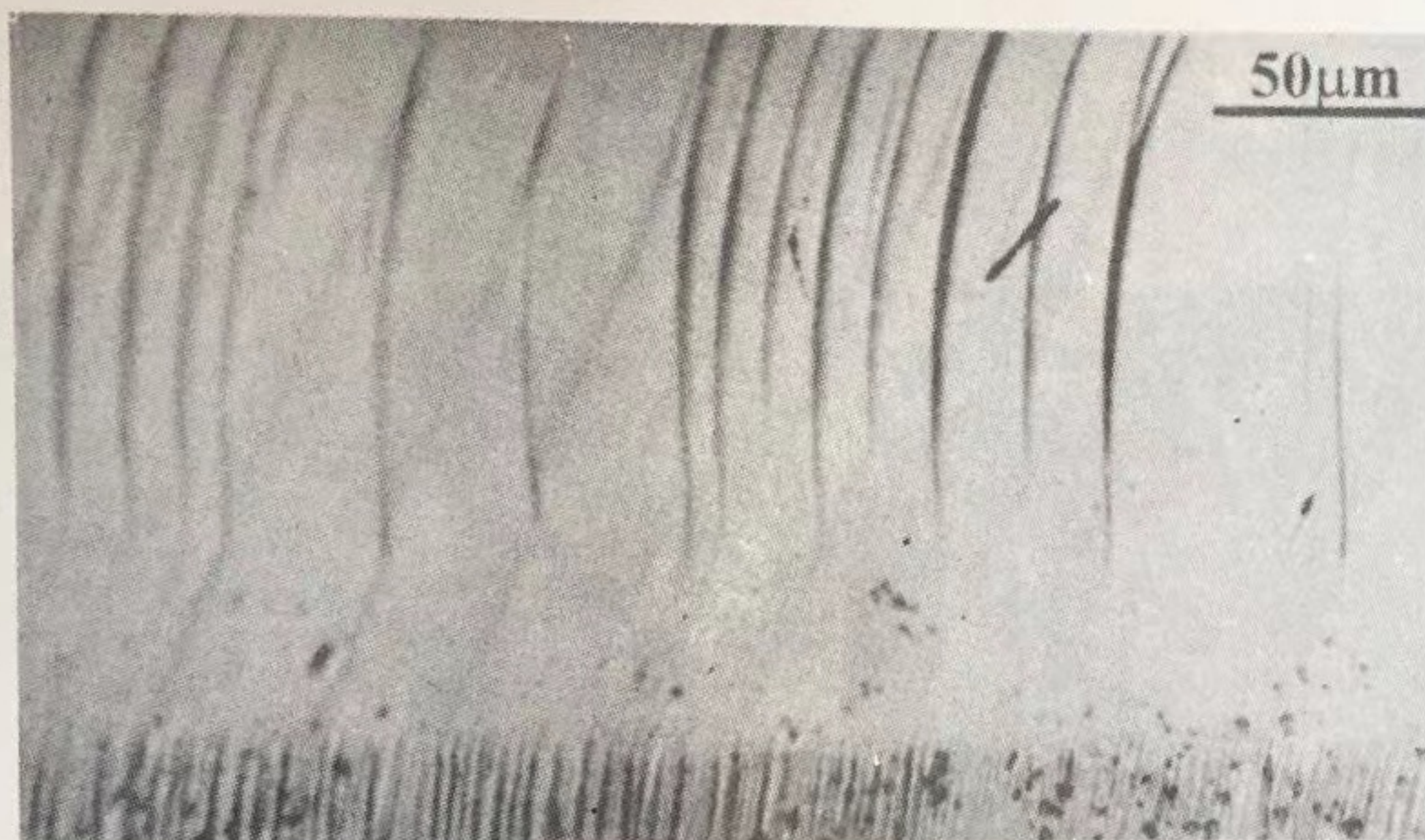
图 3 重掺硅片经历常规退火, 典型的(111)解理断面光学显微照片 室温 Wright 腐蚀 3min.
