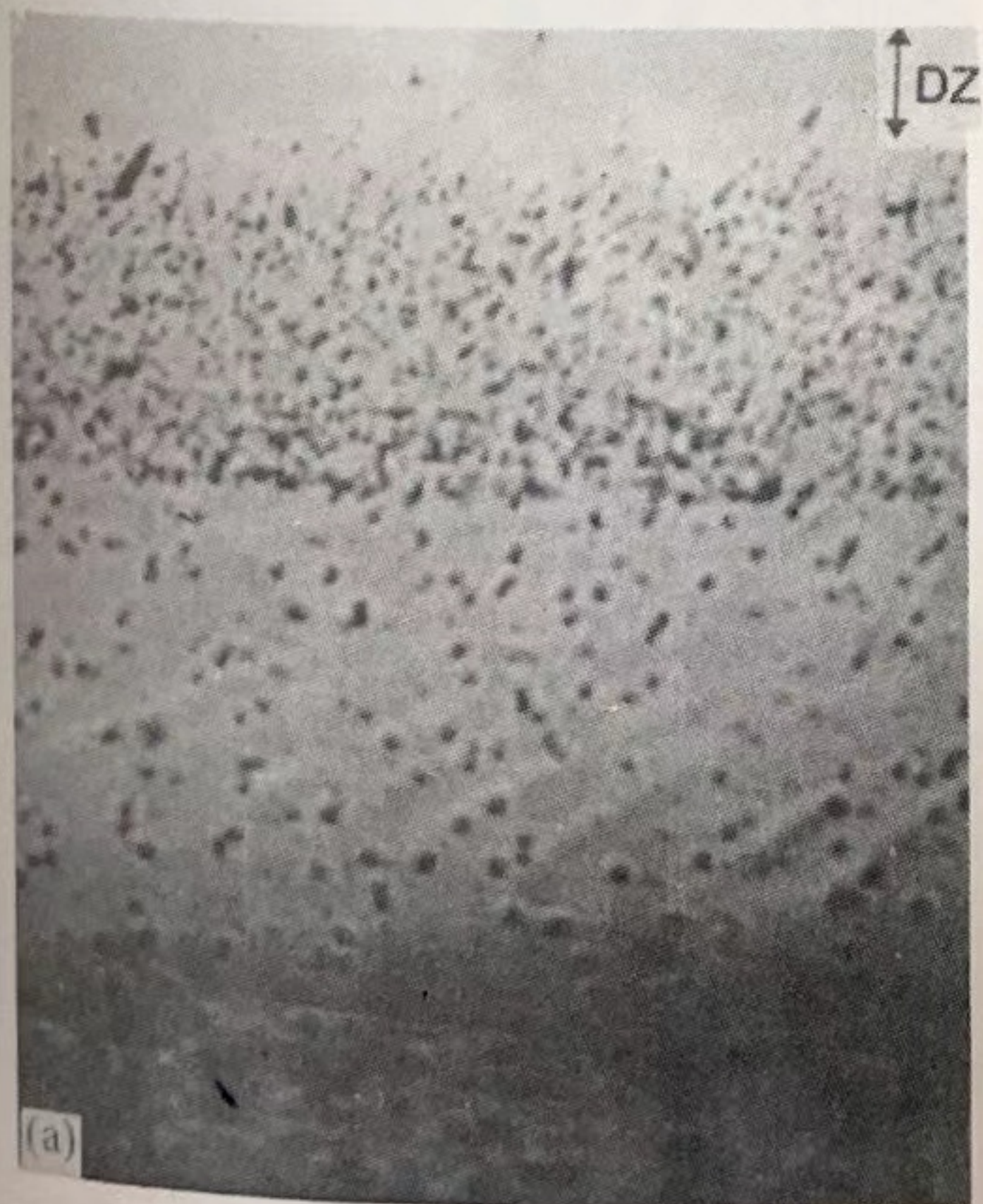
图 4 重掺硅片经历改进 ramping 退火, 典型的(111)解理断面光学显微照片 室温 Wright 腐蚀 3min; (a) 硅片表面洁净区(DZ)宽度约为 35μm, (b) 硅片体微缺陷密度为 3 \times 10^6 \text{cm}^{-2} .
