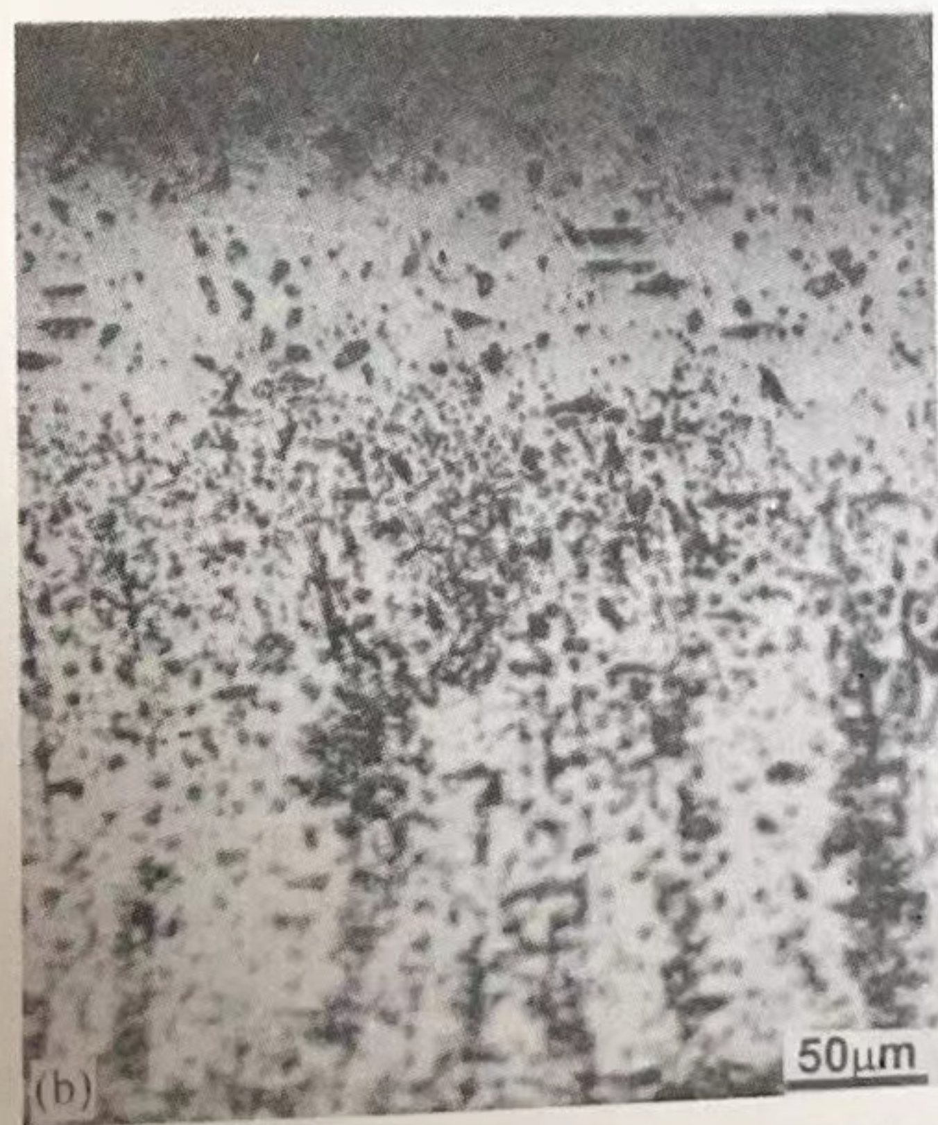
图 4 重掺硅片经历改进 ramping 退火, 典型的(111)解理断面光学显微照片 室温 Wright 腐蚀 3min; (a) 硅片表面洁净区(DZ)宽度约为 35μm, (b) 硅片体微缺陷密度为 3 \times 10^6 \text{cm}^{-2} .
