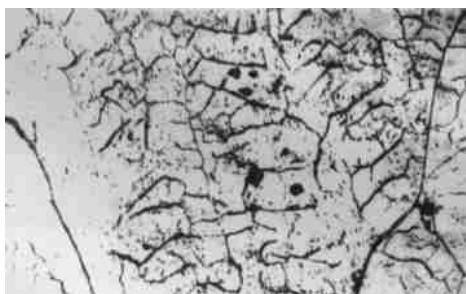
图 3 位错的宏观分布 ( \times 100 )
