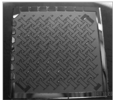
图 5 制作的微反射镜阵列照片
