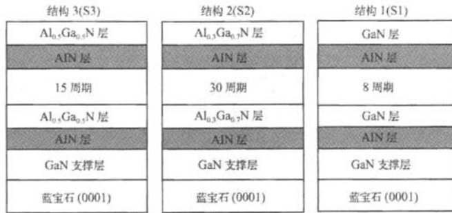
图 1 三种工作在不同波段的布拉格反射镜的结构示意图
