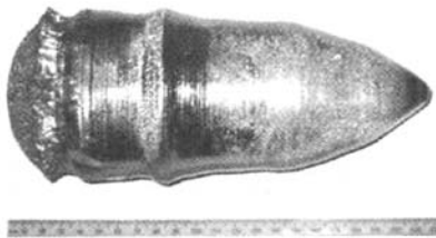
图 2 长 210mm,单晶部分 190mm 的 50mm 半绝缘 InP 单晶 Fig. 2 210mm long, 50mm diameter SI-InP with the part of single crystal of 190mm
