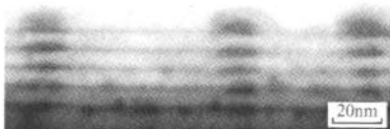
图 2 五层堆垛 InAs/GaAs 量子点样品 g = (002) 方向暗场截面 TEM 像
