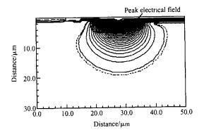
Fig. 7 Equipotential contours of HV-nMOS  $V_{gs} = 0V$ ,  $V_{ds} = 140V$ ,  $L_1 = 3\mu m$
