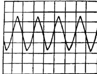
图7 21级反相器环振链波形
