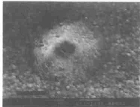
图 2(b) 磨砂后生长金刚石膜的顶视 SEM 图像
