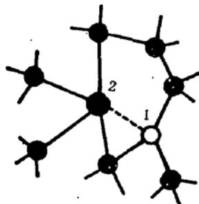
图5 Co 在非晶网络中与 Si 的结构模型
