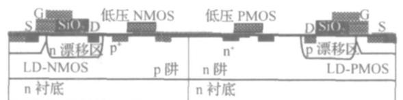
图 3 CMOS 工艺实现电平移位电路各类晶体管的单片集成
