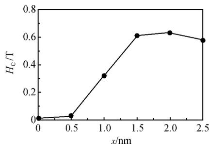
图 5  $[\text{Fe}(x)/\text{Pt}(x)]_n$  多层膜在 350℃ 热处理后的矫顽力
