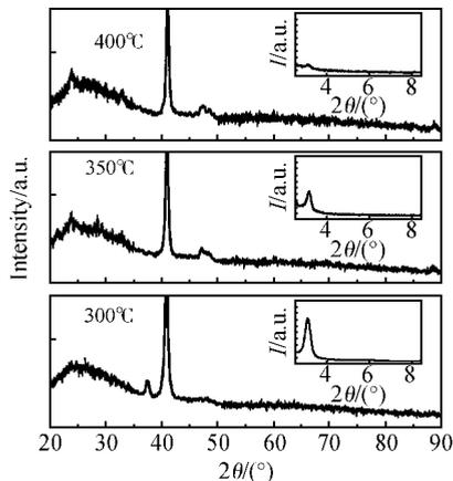
图 2 [Fe(1.5nm)/Pt(1.5nm)]<sub>13</sub> 多层膜的 XRD 谱
