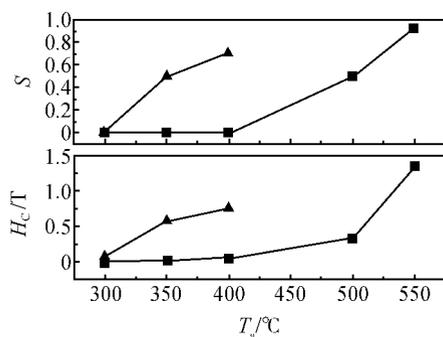
图 4  $[\text{Fe}(1.5\text{nm})/\text{Pt}(1.5\text{nm})]_{13}$  多层膜和  $\text{FePt}$  单层膜的有序度  $S$  和矫顽力  $H_c$  随热处理温度  $T_a$  的变化
