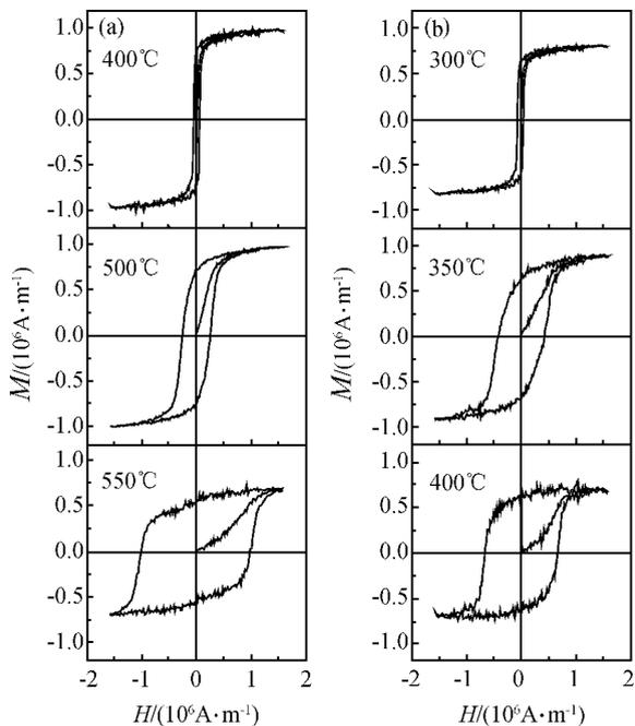
图 3  $[\text{Fe}(1.5\text{nm})/\text{Pt}(1.5\text{nm})]_{13}$  多层膜和  $\text{FePt}(40\text{nm})$  单层薄膜在不同温度热处理后样品的磁滞回线
