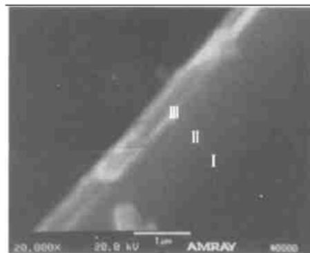
图 3 ZnO/Al/Si 的截面扫描电镜图 I 为 Si 衬底, II 为 Al 过渡层, III 为 ZnO 薄膜。
