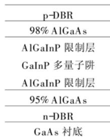
图2 器件结构示意图
