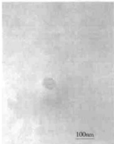
图1 450℃高压热处理10h后直拉硅单晶中和原生氧沉淀粒径相同的氧沉淀TEM照片
