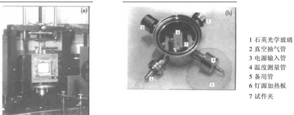
图 3 (a) 高温云纹实验炉;(b) 真空高温实验炉
