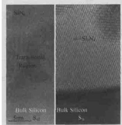
图4 S<sub>c2</sub>和S<sub>b</sub>下界面附近的高分辨透射电镜图
