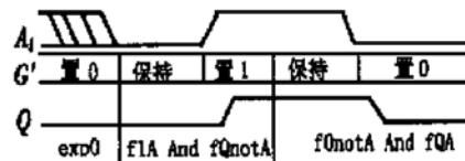
图 2 存在  $f1A \cap fQnotA$  时的  $A_i$  到  $Q$  延迟激励波形
