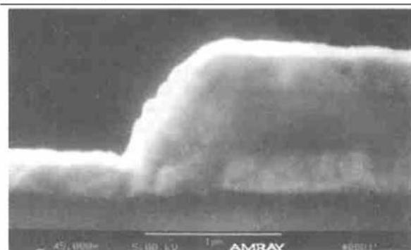
图4 侧墙的扫描电镜照片
