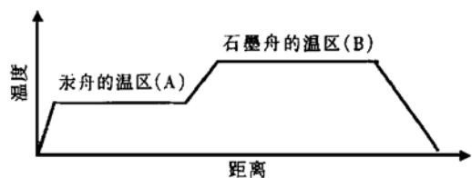
图 2 开管液相外延的生长温区示意图
