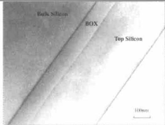
图 2 样品 S1 的 XTEM 照片 离子注入能量: 160keV, 剂量:  $5.5 \times 10^{17} \text{ cm}^{-2}$
