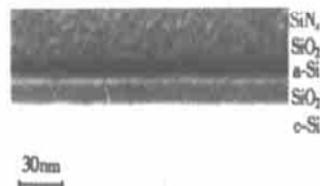
图 3 Si 衬底上等离子体氧化制备的  $\text{Si}/\text{SiO}_2/\text{a-Si}/\text{SiO}_2/\text{SiN}_x$  结构的剖面 TEM 照片
