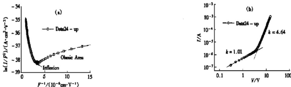
图5 用不同模型模拟结果的比较 (a) F-N 模型; (b) 带陷阱中心的SCLC模型
