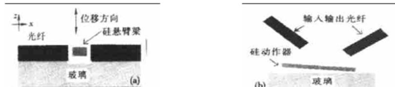
图 2 光开关耦合方式示意图 (a) 2D 耦合方式; (b) 3D 耦合方式
