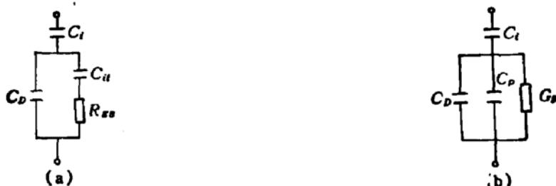
图 2 包含界面态的 MOS 结构等效电路
