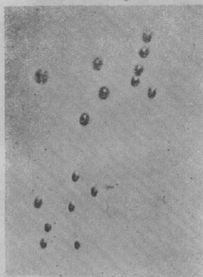
图 11 本法显示的掺 Te GaAs{100} 面的腐蚀坑分布. 21×10
