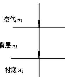
图 1 透射谱测量示意图
