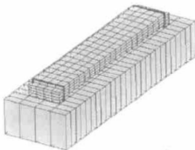
图 5 两端固支双层梁的网格化
