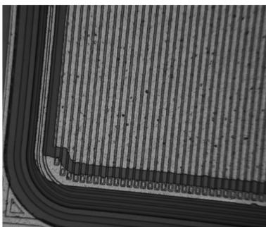
图 1 条形栅 VDMOS 的平面结构
