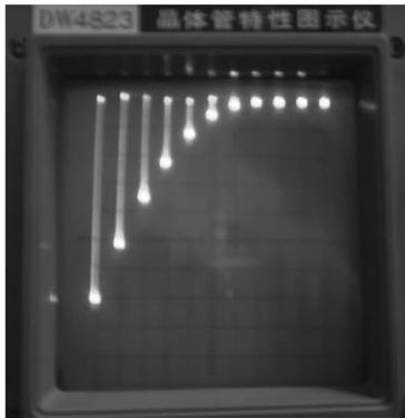
图 6  $I_{ds}$ - $V_{gs}$  曲线
