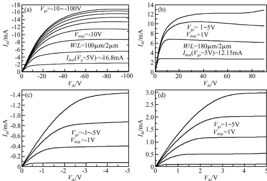
Fig.7 (a)  $I_d$ - $V_d$  curves of HVpMOS; (b)  $I_d$ - $V_d$  curves of HVnMOS; (c)  $I_d$ - $V_d$  curves of LVpMOS; (d)  $I_d$ - $V_d$  curves of LVnMOS
