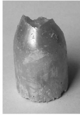
图 2 富 Pb 配料生长的 PbI 2 晶锭
