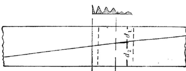
图 2 光束通过涅拉斯顿棱镜产生相位差的原理图
