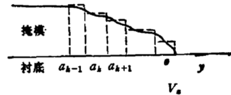
图 2 掩模边缘分割示意图
