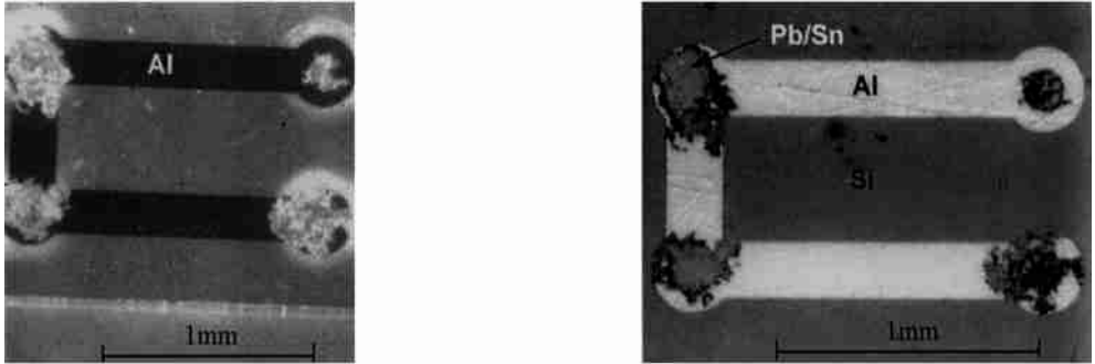
图 2 不含有下部填充料的倒装芯片中的铝腐蚀模式 (a) 红外显微镜观测(反射模式) (b) 普通显微镜观测
