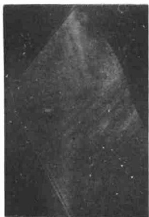
图 1 X 射线形貌相,(110)衍射面, \text{CuK}\alpha_1 辐射,50kV,20mA,17 小时
